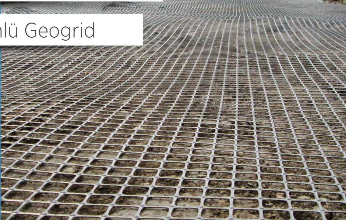
**Fortech GG Çift Yönlü Geogrid**, inşaat mühendisliğinin çeşitli uygulamalarındaki çift yönlü geogrid ihtiyaçları için geliştirilmiş, yüksek mukavemetli malzemelerdir. Polyester mikro iplikçiklerin dikdörtgenler şeklinde örülüp üzerinde PVC ile kaplanması yöntemiyle üretilir.
